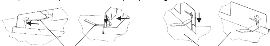
Rys. 1 Sposób zabezpieczenia kołnierza podtynkowego w suficie
